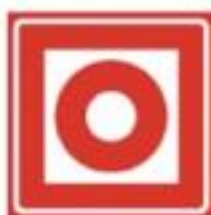
Pulsador de alarma
